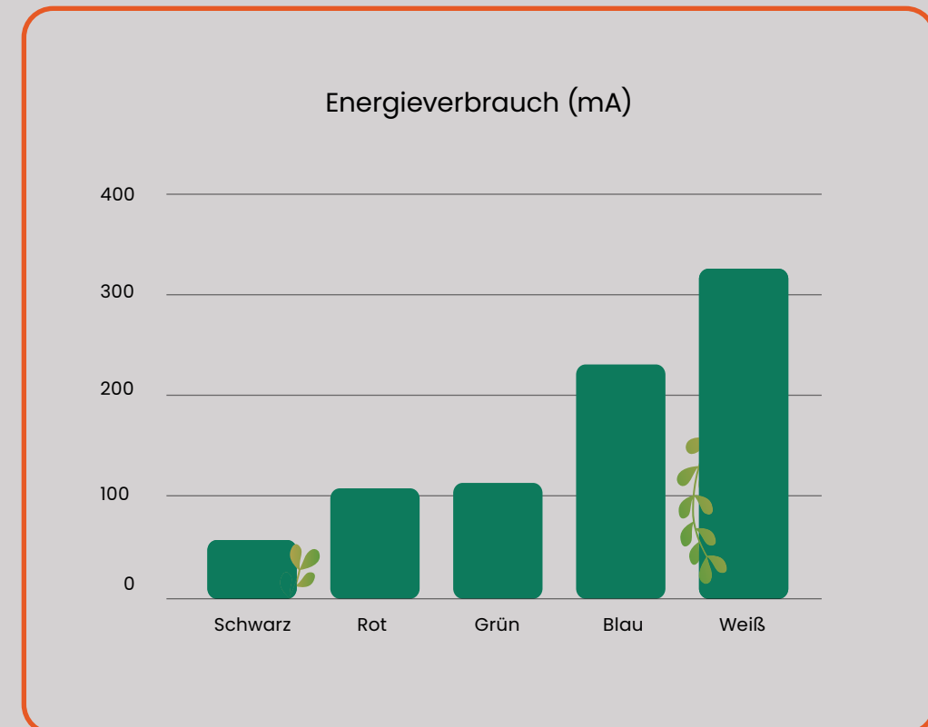
Abb. 2: Darstellung des Energieverbrauchs von Farben auf OLED-Displays
